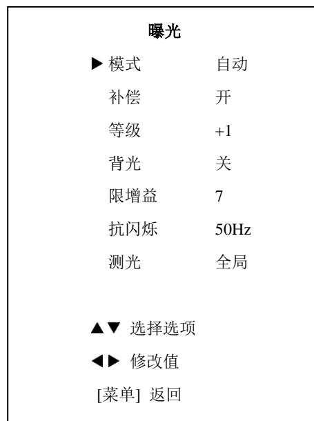
曝光模式：可设置项：自动、手动、快门优先、光圈优先、亮度优先、宽动态
